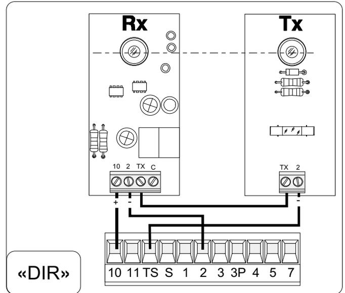
При подключении фотоэлементов в режиме тестирования блок управления будет каждый раз при подаче команд "Открыть" или "Заккрыть" проверять их работоспособность. При неработоспособности фотоэлементов светодиодный индикатор на блоке управления будет мигать; команды, подаваемые с кнопок управления или брелка-передатчика, блокируются.
