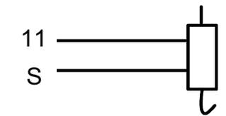
Выход для подключения электрозамка (12В, 15Вт)
