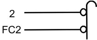
Вход для подключения концевых выключателя закрывания (2 двигатель).
