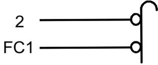
Вход для подключения концевых выключателя закрывания (1 двигатель).
