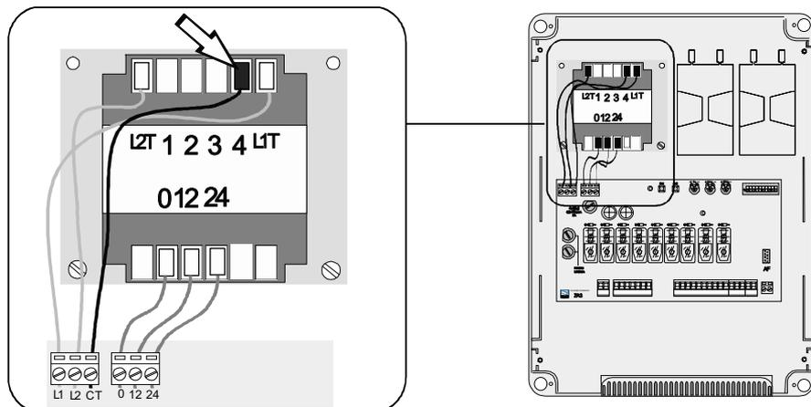
Для изменения усилия привода переключить клемму, обозначенную на рисунке, в одну из четырех позиций (1 - мин., 4 - макс.)
