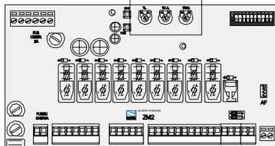
**TCA** - Регулировка времени автоматического закрывания (1-120 с)
