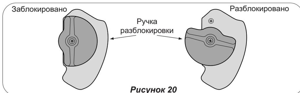
**ВНИМАНИЕ!** Разблокировка привода должна выполняться только при выключенном двигателе!
