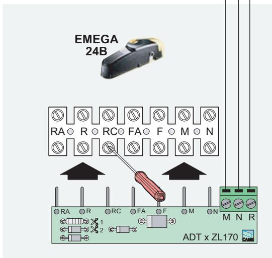
Примечание - Клемма RA не используется при подключении к приводам FERNI, FAST, EMEGA
