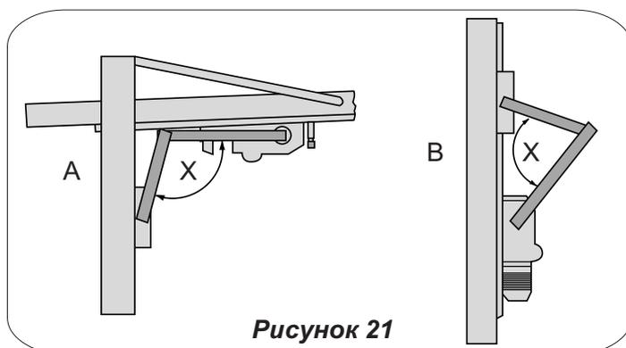
Вручную поднять и опустить ворота: ворота должны оставаться в равновесии в любых положениях. Если это не так, выполнить регулировку противовесов следующим способом:
