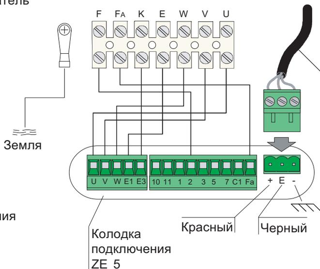
Экранированный кабель (тип 2 4 0 2 С 2 2 4 W G) для подключения кодера. При установке двух приводов используется кабель только одного из них. Если ZE5 устанавливается не на несущем профиле, максимальная длина кабеля не должна превышать 5 м.
