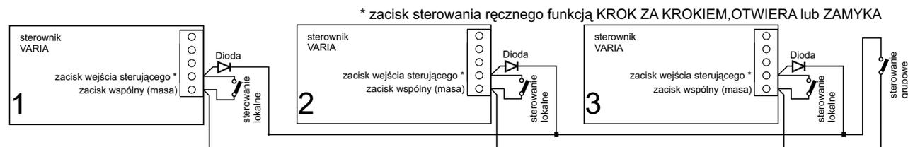
Rys.4 Schemat podłączenia sterowników VARIA przy zarządzaniu grupowym przyciskiem.
