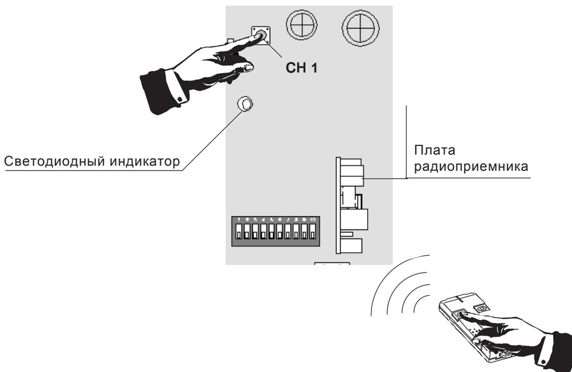
**ВНИМАНИЕ!** При использовании в качестве брелков-передатчиков TOP432M, TOP434M, TOP432S, измените установленный на заводе-изготовителе код. Изменение кода производится изменением положения 10-позиционного микропереключателя, находящегося под крышкой
